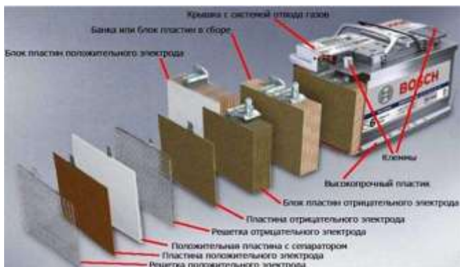
Рис. 2 – Устройство герметизированной АБ с загущенным электролитом
