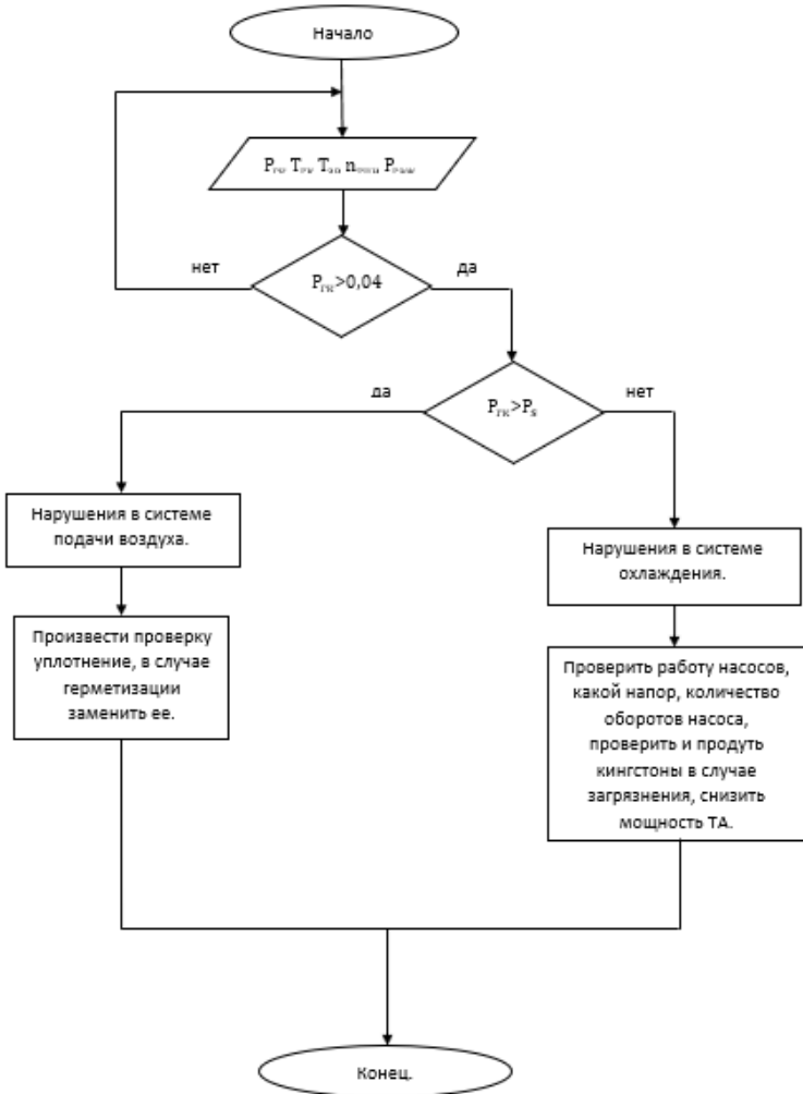
Рис. 1 – Алгоритм управления ГК при снижении вакуума в ГК.
