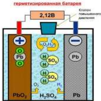
Рис. 1 – Устройство клапанно-регулируемого СКА
